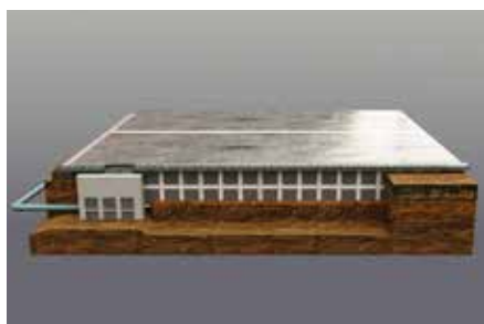
Een innovatieve wegopbouw in combinatie met speciale geprefabriceerde betonnen elementen laten de Slijperstraat in Staden functioneren als een onbewerkte akker terwijl hij even duurzaam is als een klassieke weg, zelfs bij veel en zwaar verkeer! - © Aquafin nv
